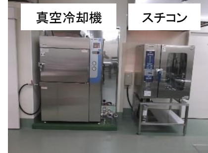
スチコンによりボイルした和え物野菜を真空冷却機で急速に冷却します
